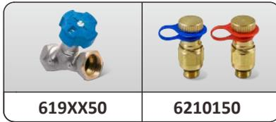
Балансировочный клапан Balanflow серии 619XX50 используется для гидравлической балансировки трубопроводной сети систем отопления, охлаждения и ГВС. Клапан позволяет менять и фиксировать его пропускную способность с защитой настройки от несанкционированного изменения, а также полностью перекрывать поток, перемещаемый по трубопроводу системы. При помощи опциональных штуцеров через дифференциальный манометр можно измерить фактический расход через клапан.
