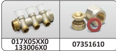
Коллектор для водоснабжения с регулирующими вентилями на 2, 3 и 4 выхода диаметром 1/2" с наружной резьбой применяется для распределения потоков жидкостей в контурах теплого пола, холодного и горячего водоснабжения. На каждом выходе предусмотрен вентиль для регулирования расхода рабочей среды. Коллекторы позволяют не только полностью открыть/закрыть поток, но и точно регулировать расход по каждому потребителю.
